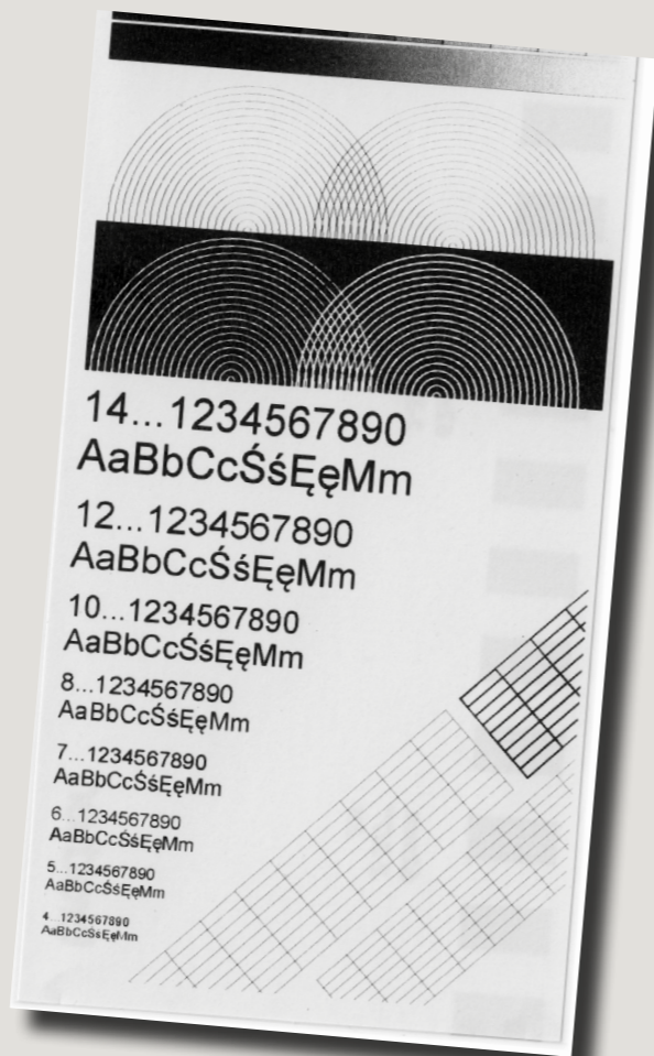
Drukarki termiczne mają swoje ograniczenia, na przykład jeśli chodzi o ilość możliwych przejść tonalnych czy rozdzielczość i czytelność szczegółów. Jednak na tej drukarce jesteśmy w stanie uzyskać czytelne napisy 4-punktową czcionką, wyraźne cienkie skośne linie. W przypadku fragmentów w kontrze na pewno należy zastosować nieco większy stopień pisma czy grubość linii.
